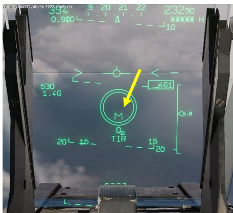
VTH im Super 530D Modus für eine Neuaufschaltung
