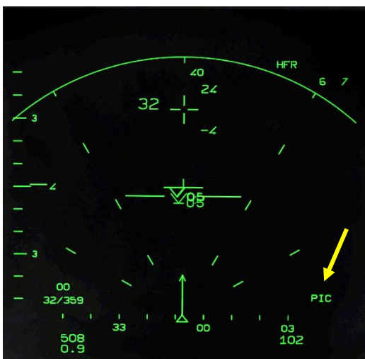
VTB im RECH Modus und PIC Modus ausgewählt
