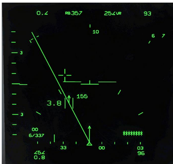
VTB mit PID/TWS Aufschaltung
