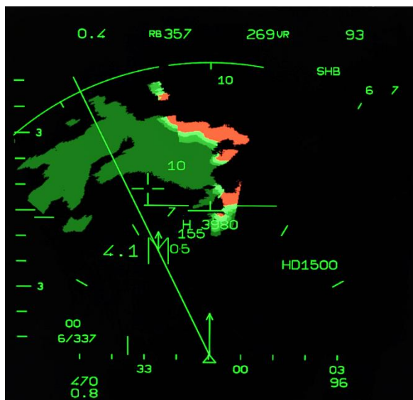
VTB im SHB Modus (PID/TWS Aufschaltung mit DEC aktiviert)
