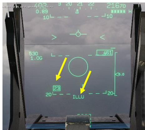
VTH im Super 530D Modus, Kontakt nicht heraufschaltbar.
