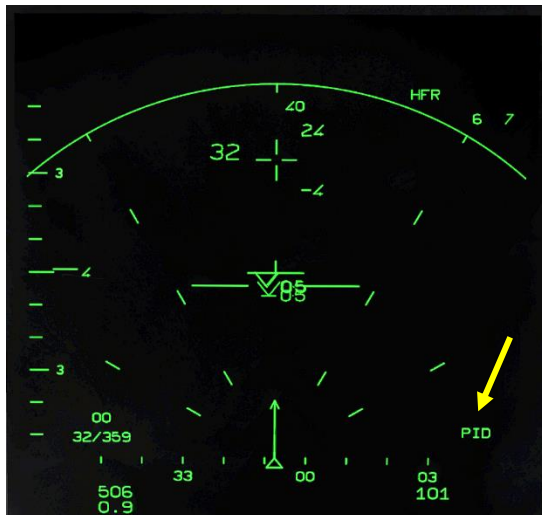
VTB im RECH Modus und PID Modus ausgewählt
