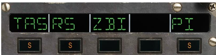
Freifallende Bomben mit PI Modus Unterstützung
